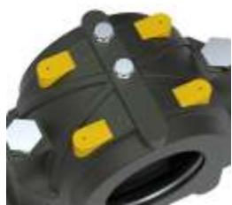
Die Ankörnungspunkte im Oberteil können zur Positionierung von Gewindebohrungen genutzt werden. Werksseitig sind bereits Schmierbohrungen vorhanden.
